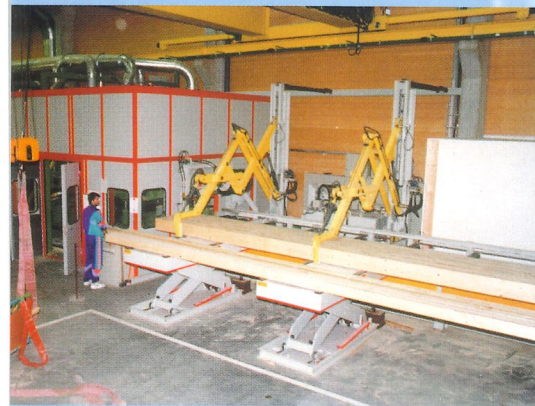
Hobelanlage für Brettschichtholz bis 1100 mm Arbeitsbreite.
