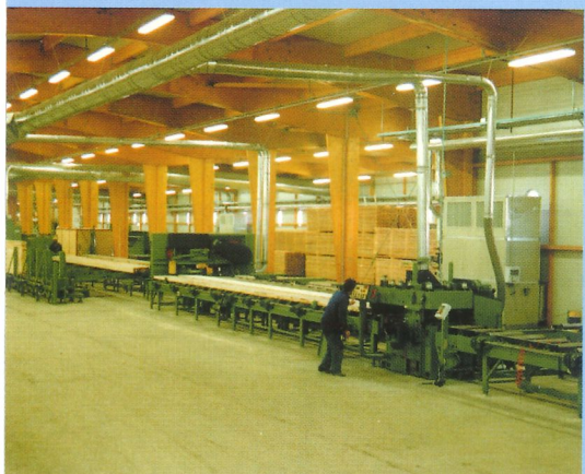
BSH-Anlage mit Prinzip: große Blöcke pressen; horizontal und vertikal auf kleinere Querschnitte schneiden.
