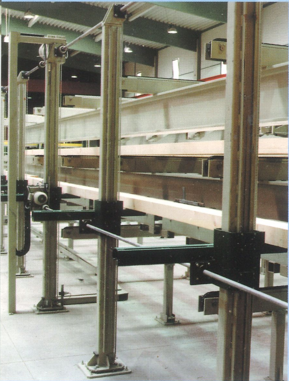
Aushärte-Etagenlager für KVH, geeignet für Keilzinkenverbindungen mit kurzen Aushärtezeiten.
