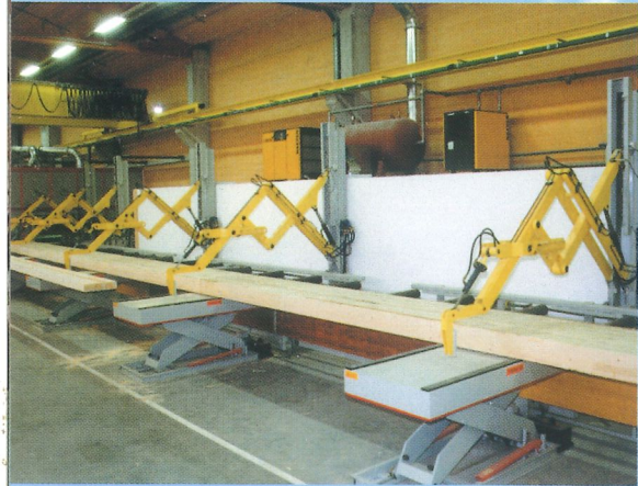
Automatische Abstapelung mit Hubtischen. Automatic destacking with lifting tables.
