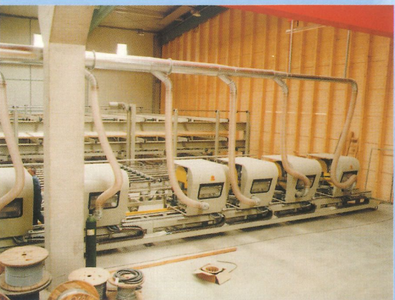
Aushärteförderer und Mehrfachablängsäge Glue-drying conveyor and multiple cross-cutting saw
