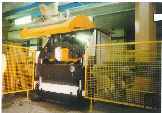
Spaltsäge für Kreuzbalkenproduktion aus Halbstücken.
