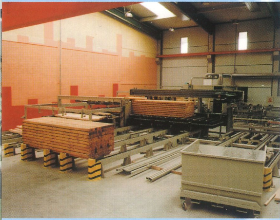
Paketaufgabe, Längsabschieber Packet conduction, longitudinal push-off
