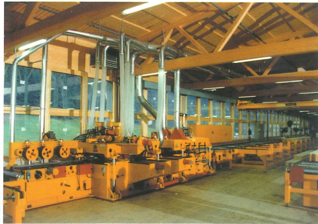
Hobelanlage mit CNC Steuerung zum profilieren von Brettschichtholz und Hohlbalken.
